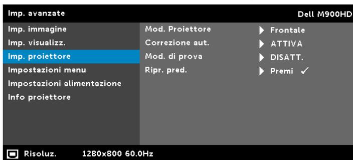
**MOD. PROIETTORE**—consente di selezionare la modalità del proiettore, in base a come è montato l'apparecchio.
